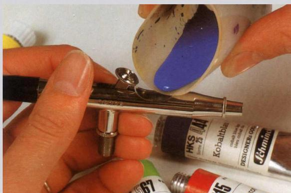
*Der Aerograph mit der Düse von 0,15mm und dem kleinsten Behälter.*
