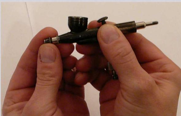
Die Düse schrauben wir mit einem originellen Schlüssel ab, delikat, um das Gewinde nicht zu überdrehen. Nun bleibt uns in Händen der Aerographkörper, den wir nicht weiter auseinander-schrauben. Alle abgenommenen Elemente waschen wir mit spezieller Reinigungsflüssigkeit (ab und zu kann das auch Destillierwasser sein es ist billiger) mithilfe eines weichen Pinsels. Beim Waschen sind die populären Wattebäusche und Küchenrollen sehr behilflich.
