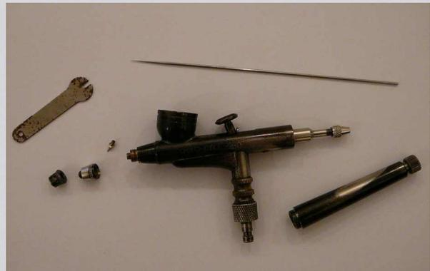
*Aerographenelemente die zur jeweiligen Reinigung bestimmt sind. Der Hauptrumpf und dessen Teile können wir seltener waschen. Häufiges Auseinanderschrauben dieser Elemente kann zu Undichtheit führen.*
