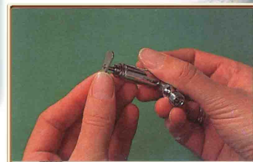
Jej szpica jest niezwykle precyzyjna i najmniejsze uszkodzenie wymaga wymiany na nową (ok. 50 PLN). Igłę należy wkładać po dokręceniu dyszy, ruchem obrotowym, kontrolując, aby nie dotknęła swym czubkiem niczego po drodze. To trudne. Po dokonaniu montażu wszystkich elementów należy
