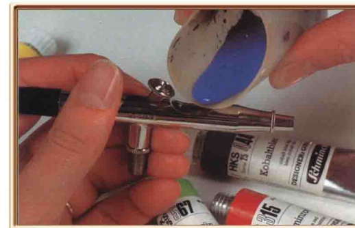
Aerograf z dyszą 0,15 mm i najmniejszym pojemnikiem na farbę.
