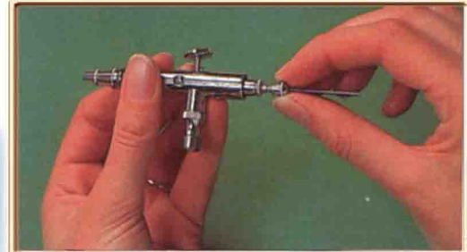
blokadę igły - tylko w mniejszości konstrukcji). Po wyjęciu igły i ułożeniu jej na stanowisku czyszczącym czas na odkręcenie kapy ochrony dyszy. Po odkręceniu dwóch kap (wyłącznie ręcznie!) odsłoniła się precyzyjna dysza. To jest naj-
