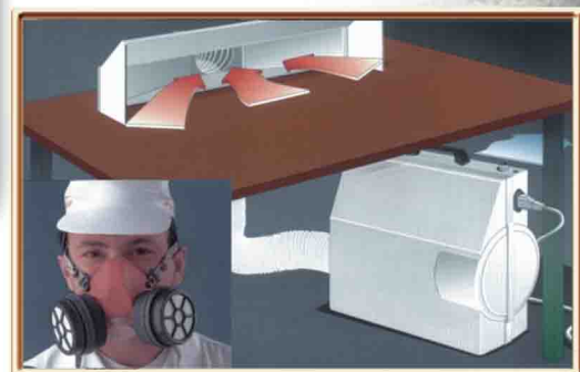
Urządzenie stolikowe pochłaniające odkurz farby przy malowaniu ilustracji oraz maska z filtrem do pracy przy dużych obiektach.
