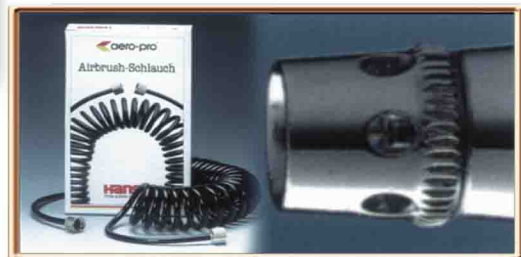
Spiralny przewód powietrza do aerografu oraz specjalna kapa na dyszę z otworami uniemożliwiającymi gromadzenie się nadmiernej ilości farby wokół dyszy (tylko opcjonalnie).
