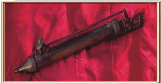
Pierwsza konstrukcja Burdicka zmodyfikowana do potrzeb malarstwa artystycznego (1890r.).
