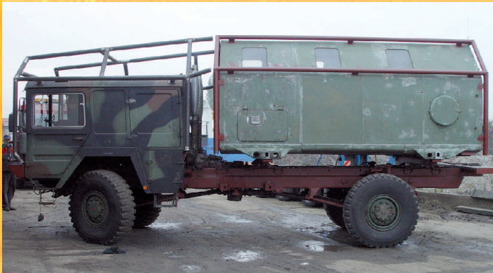
Kontener i szoferka zostały zabezpieczone przed uszkodzeniem systemem orurowań.
