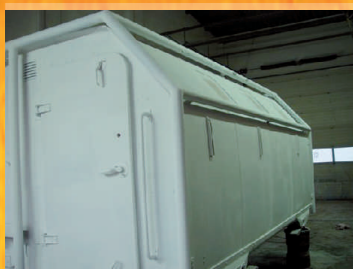
Kontener po zabudowaniu wnętrza wrócił do Redy i został zabezpieczony białym podkładem.
