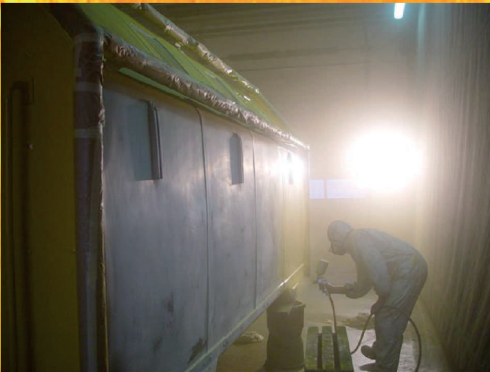
Rozpoczęto pierwszy etap malowania kontenera kolorem żółtym, cytrynowym RAL 1016.
