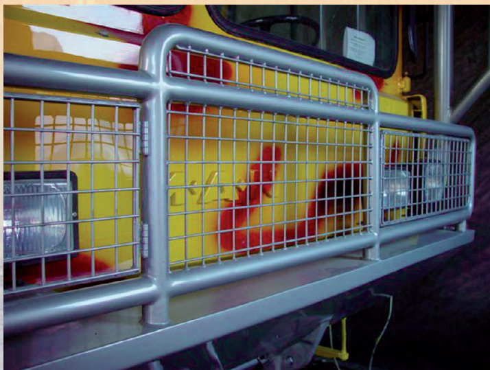
Jak widać, siatki stalowe wraz z orurowaniem, chronią również reflektory główne i zapasowe.
