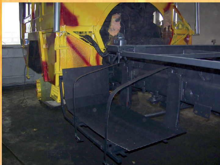
Półka na dodatkowe zbiorniki paliwa z pasami mocującymi oraz fragment gotowej ramy.
