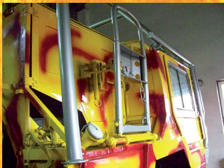
Gniazdo bocznego koła zapasowego i jego elementy kontrastujące z resztą karoserii.
