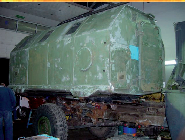
Kontener mieszkalny LAK II został przymocowany do ramy w czterech miejscach.
