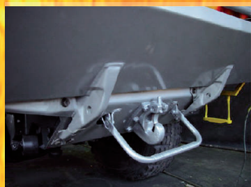
Zderzak, wyciągarka, rama i elementy podwozia po remoncie wyglądały jak nowe.
