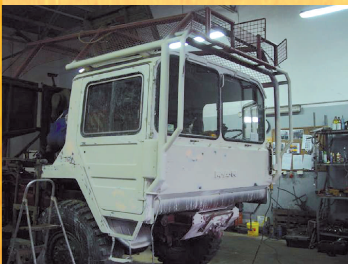
Szoferka wraz z orurowaniem po wyszpachlowaniu została zabezpieczona podkładem MF.
