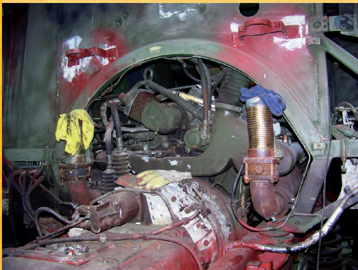
Podczas prac blacharskich układ wydechowy został wymieniony na nowy.
