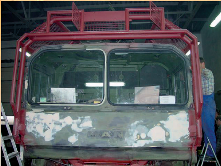
Orurowanie zabezpiecza szyby i oświetlenie samochodu przed gałęziami lub stłuczeniem.
