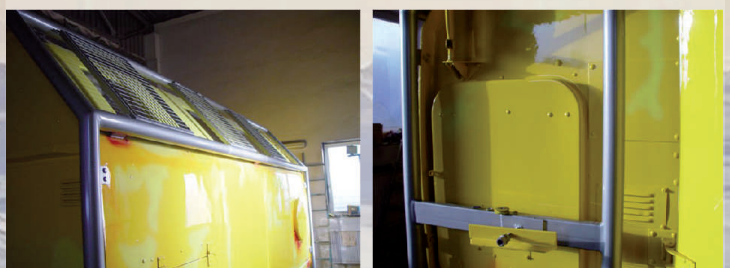
LAK II od prawej strony oraz tył kontenera z mechanizmem dźwigu koła zapasowego.
