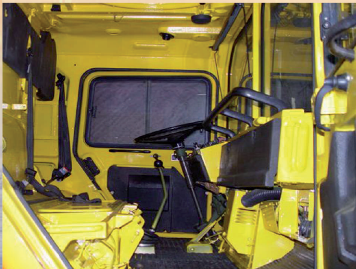
Wnętrze szoferki pomalowano jednolitym kolorem RAL 1016.
