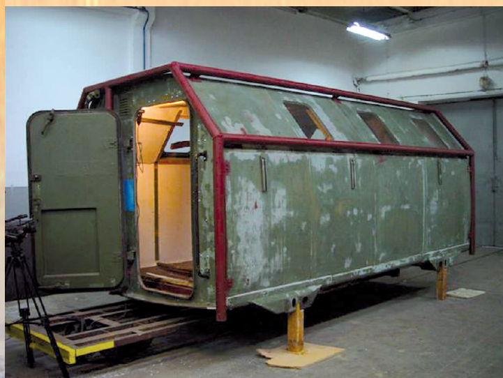
LAK II z orurowaniem i powierzchnią do malowania przed przewiezieniem do zabudowy.
