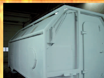
Kontener po zabudowaniu wnętrza wrócił do Redy i został zabezpieczony białym podkładem.
