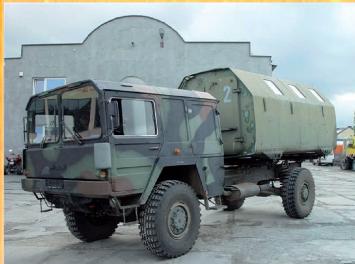
"Przymiarka" kontenera do samochodu w celu pobrania wymiarów dla nowej konstrukcji.
