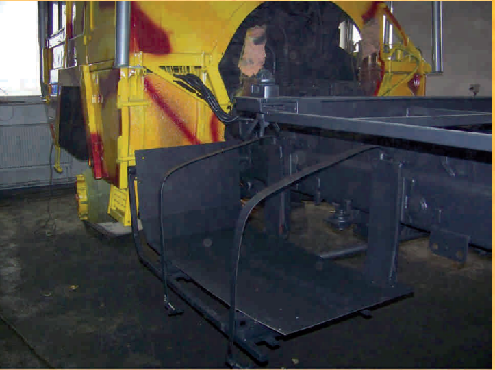
Das Gestell für zusätzliche Treibstofftanks samt Spanngurte sowie ein Teil des fertigen Rahmens.
