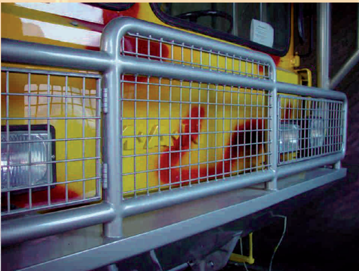
Wie man sieht, schützen die Stahlgitter mit Berührung auch die Haupt- und Ersatzscheinwerfer.
