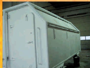
Das Container nach Ausstattung des Innenraums kam nach Reda zurück und wurde mit weißem Grundanstrich geschützt.
