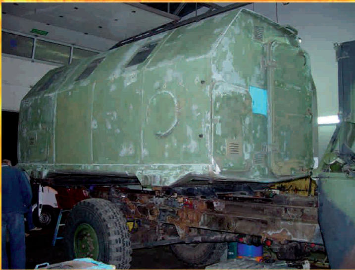
Das Wohncontainer LAK II wurde an den Rahmen an vier Stellen befestigt.
