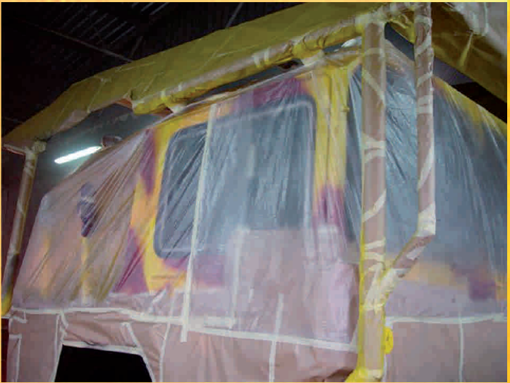
Die während des Anstrichs der zusätzlichen Fahrgestellelemente zugedekte Kabine.
