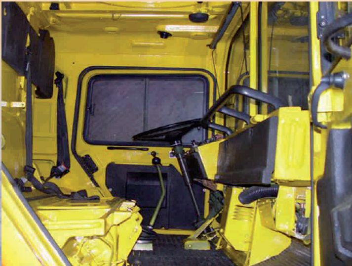
Das Innere der Fahrerkabine wurde mit einheitlicher Farbe RAL 1016 angestrichen.
