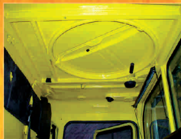
In der Kabine wurde die Luke betätigt, die früher als Schützenstand diente.
