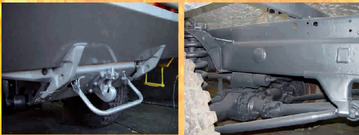
Die Stoßstange, die Schleppwinde, der Rahmen und die Fahrgestellelemente sahen nach der Renovierung wie neu aus.
