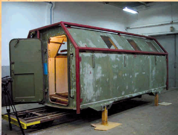
LAK II mit Berohrung und der Anstrichfläche noch bevor es mit Möbeln ausgestattet wurde.
