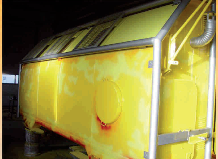
Das Container mit „feurigen“ Details nach der Demontage der Maskierung von der Berohrung und von dem Rauchabzug des Herdes „koza“.
