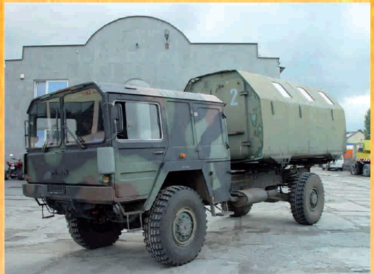
„Anprobe“ des Containers zu dem Fahrzeug zwecks Bestimmung der Ausmaße für neue Konstruktion.
