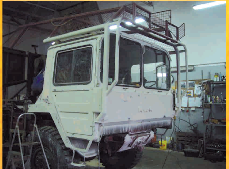
Die Fahrerkabine mit der Berohrung wurde nach dem Spachteln mit MF Grundierung geschützt.
