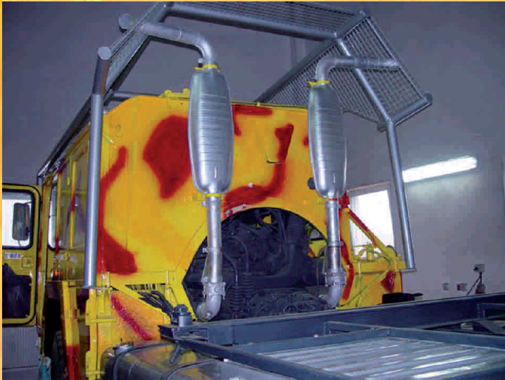
Abschluss der mit dem Auspuffsysteem verbundenen Arbeiten. Das Auto ist bereit zur Montage des Containers.
