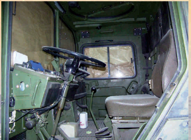
Die Fahrerkabine in der ursprünglichen Version konnte das Überleben während des sibirischen Winters nicht garantieren.
