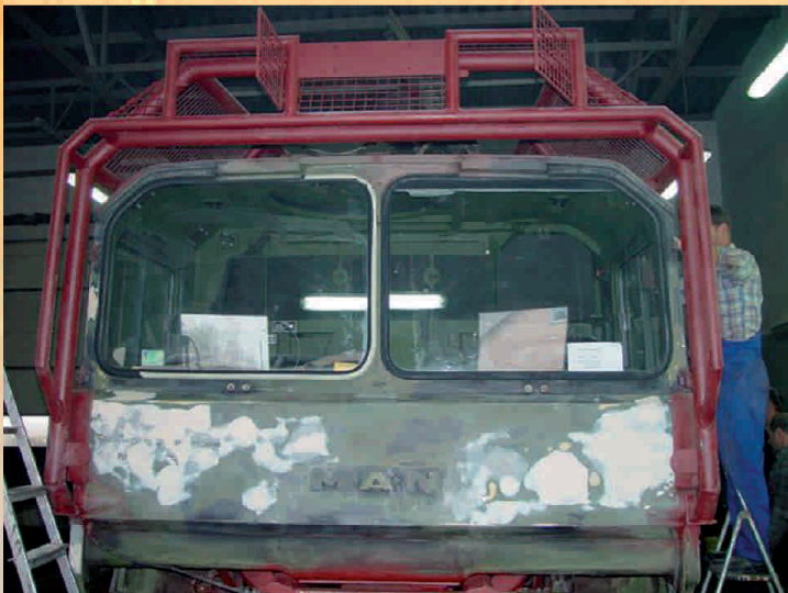
Die Berührung schützt die Scheiben und Beleuchtung des Fahrzeugs vor Ästen und dem Zerbrechen.
