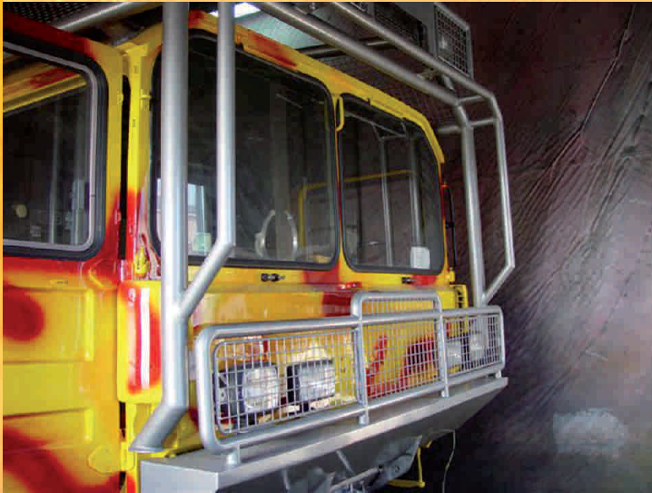
Nach dem Auftragen des Klarlacks hat man die Montage der vorderen Beleuchtung angefangen.
