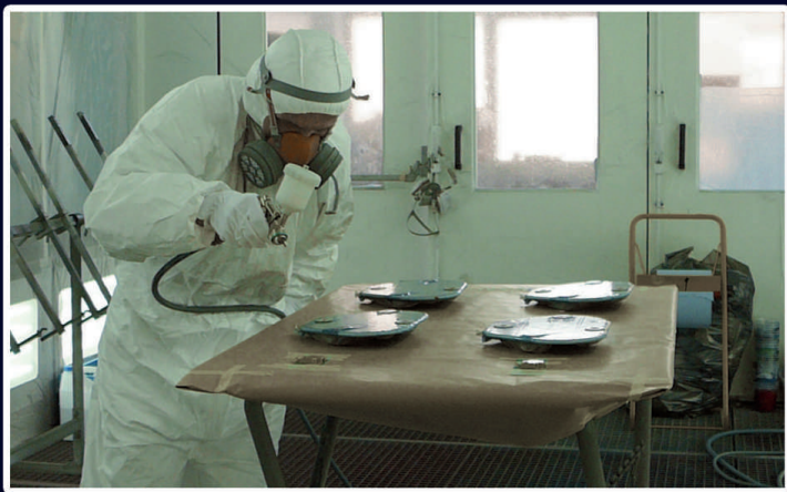
Нанесение последующих слоёв лака MAP COATIGS.
