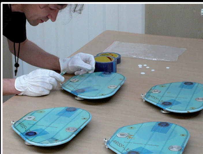
Маскировочные работы были повторены на четырёх антеннах.
